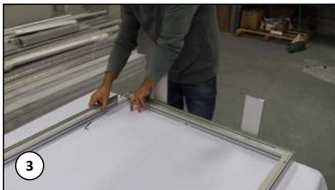
2. Insérer 2 équerres à chaque extrémité de l'extrusion, puis serrer avec la cré Allen.
